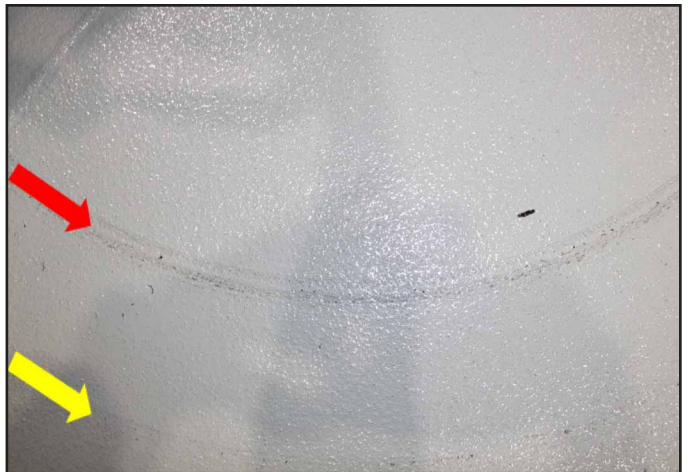
Verschleißtest an der TU Kaiserslautern. Der Testboden - StoFloor Traffic Elastic 590 EP (OS 8.15) - wurde mit Einkaufswagen-Rollen überfahren, um diese spezifische, punktuelle Belastung zu simulieren. Das Bild zeigt den Boden nach 25.000 Zyklen. Es ist kein Verschleiß erkennbar, lediglich etwas Abrieb der Rollen. Auch nach Abschluss der Testreihe mit 150.000 Überfahrten war der Boden ohne Schäden.
