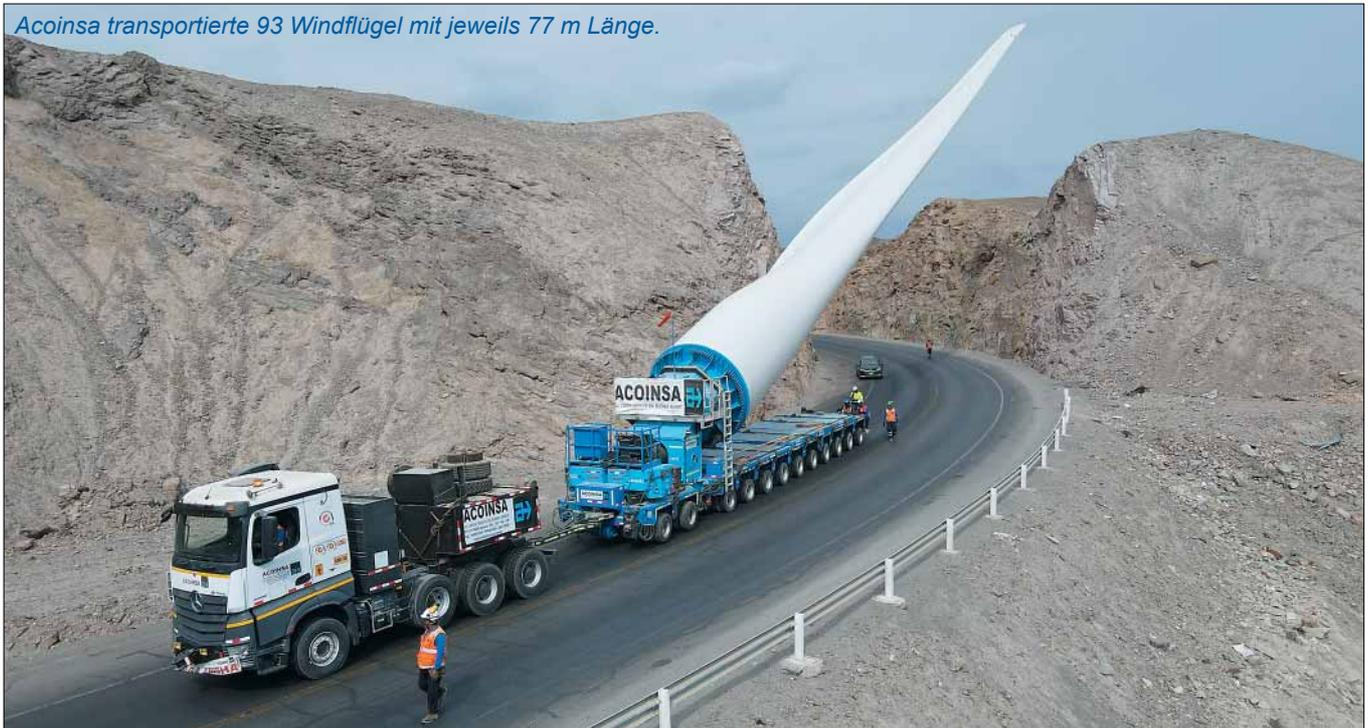
zu teleskopierbaren Fahrzeugen deutlich mehr Bodenfreiheit. Mit »BLADES« können wir Kreisverkehre oder beengte Abbiegesituationen schneller als bisher bewältigen. Mit bereits vier ausgelieferten »BLADES« Garnituren sowie den weiteren sechs geordneten sind wir hochzufrieden und für den sicheren und schnellen Transport von Windkraft-Bauteilen der neueren Generation bestens gerüstet.“
