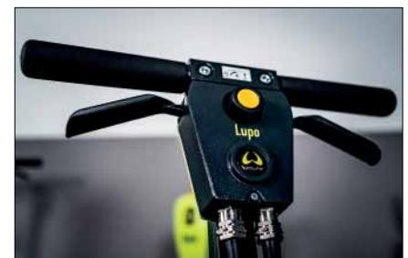
Die Arbeitsbreite von 250 mm, kombiniert mit der stufenlosen Messerwinkelverstellung, entfernt PVC-Böden ebenso wie Linoleum, Kautschuk und textile Bodenbeläge rückstandsfrei.
