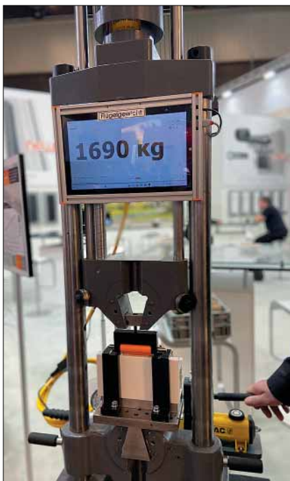
Bei einem Flügelgewicht von 1.690 kg ist auch die festeste Verbindung ausgereizt.
