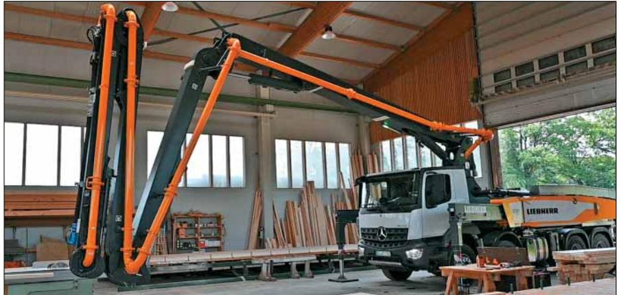
Die Autobetonpumpe 31 XXT kann dank LiDriveIn auch in niedrigen Hallen arbeiten.
