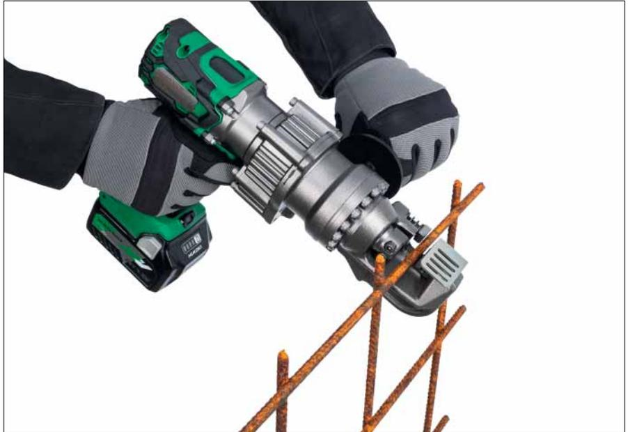
Seine vielfältigen Vorteile spielt der KSD-16 ACBL nicht allein beim Einsatz auf der Baustelle aus. Auch beispielsweise in der Betonfertigteileproduktion ist die kabellose Freiheit und das geringe Gewicht des Werkzeugs relevante Vorteile. Erhältlich ist der neue Baustahlschneider als Version mit und ohne Akku. Zum Lieferumfang im praktischen Transportkoffer gehört in der Komplettversion über Akku und Schnellladegerät hinaus noch ein individuell positionierbarer Handgriff.
