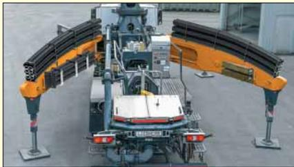
Kompakte Autobetonpumpe 9
