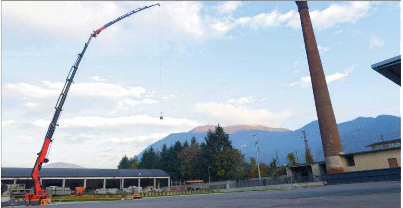
Mit dem F2350RL-HXP TECHNO setzt Fassi neue Maßstäbe im Kransektor der Zukunft. Dieser Kran, der leistungsstärkste, den Fassi jemals gebaut hat, ist weltweit der erste mit 18 Hydraulikauschüben und einer Reichweite von bis zu 46,37 m. Eine perfekte Kombination aus Kraft, Präzision und Technologie, die alle Erwartungen übertrifft.
