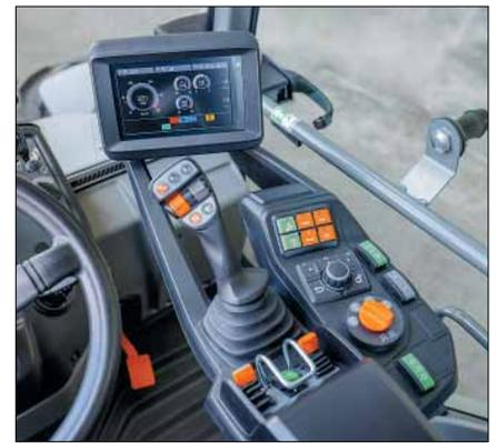
nale 7-Zoll Display eröffnet eine neue Welt an Maschineneinstellungen und Assistenzsystemen. Per Jog-Dial kann zum Beispiel die Joysticksensitivität oder die Ölmenge vom 3. Steuerkreis angepasst werden.
