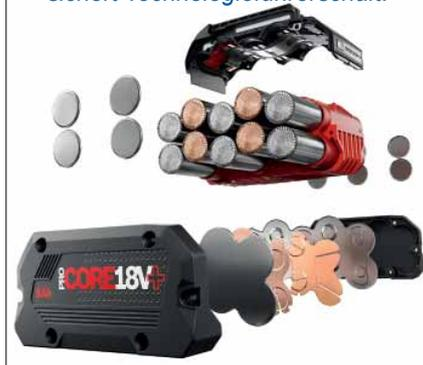
beiden Seiten entlang der gesamten Länge von Anode und Kathode. Dieses neue Design senkt den Widerstand jeder einzelnen Zelle um circa 50 % und damit den des gesamten Akku-Packs maßgeblich. Dadurch bildet sich deutlich weniger Wärme, die bei anspruchsvollen Anwendungen ein limitierender Faktor ist. Das Ergebnis: Bis zu 71 % längere Laufzeit als herkömmliche Akkus dank der Kombination aus Tabless-Design und einem genau darauf abgestimmten Akku-Management.
