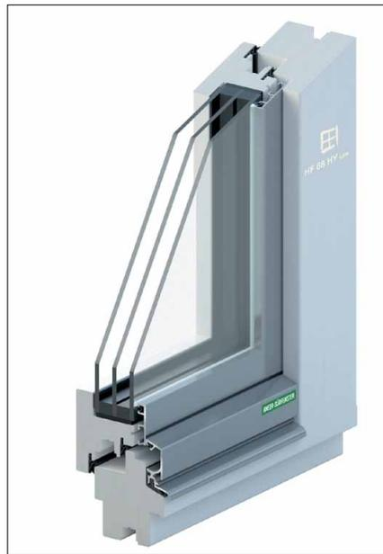
Durch eine komplett umlaufende, außen aufgesetzte Aluminiumschale ist der Flügel noch witterungsbeständiger und sorgt für eine puristisch-klare Ansicht. Sogar in schlanken 68 mm Flügeln lässt sich bis zu 46 mm 3-fach-Isolierverglasung einbauen – damit ist das neue Holzfenster HF 68 von Kneer-Südfenster die Nr. 1 für Gebäudesanierungen mit hohen Ansprüchen an den Wärme- und Wetterschutz.
