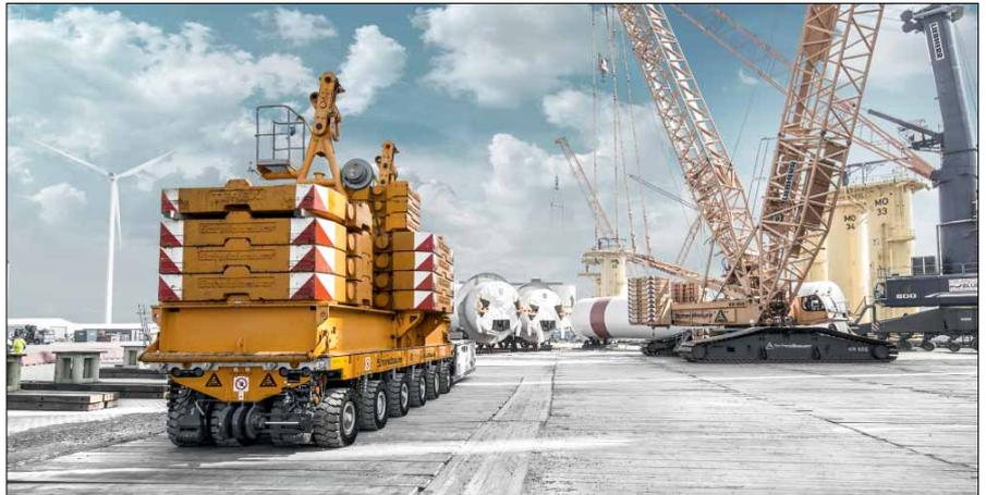
*Starke Basis für die Windkraft: Scheuerle SPMT beim Transport von Kran-gewichten, die für den Aufbau leistungsstarker Windkraftanlagen benötigt werden.*
