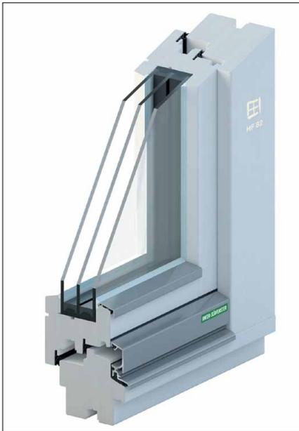
Bei den neuen Standard-Holzfenstern HF 68, HF 82 und HF 90 von Kneer-Südfenster unterscheiden sich die äußere und innere Ansicht nicht. Das standardmäßige Flügelabdeckprofil und die standardmäßig vorgesetzte Regenschiene erhöhen den Wetterschutz.
