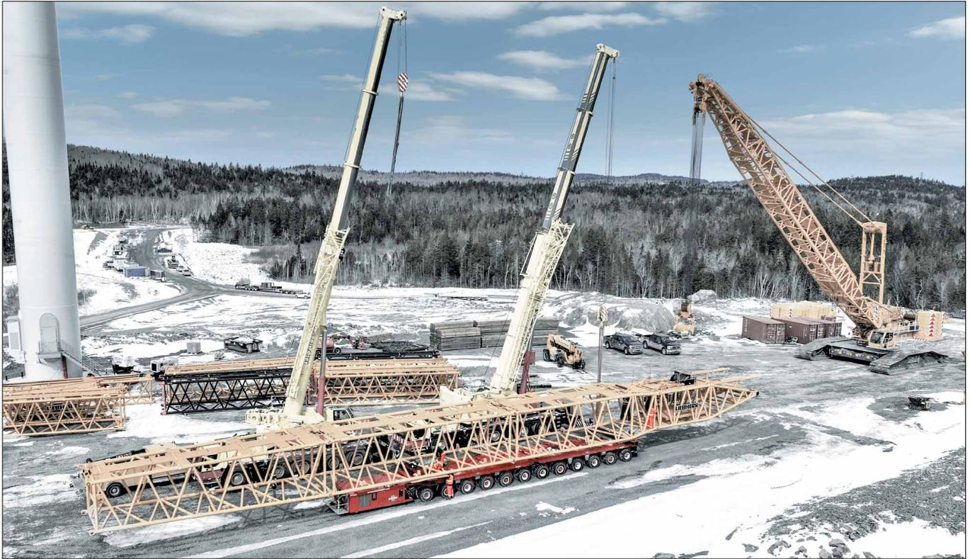
*Scheuerle SPMT bieten durch elektronische oder mechanische Koppelung eine theoretisch unbegrenzte Transportkapazität – perfekt für Großprojekte in der Energie-, Bau- und Bergbauindustrie.*
