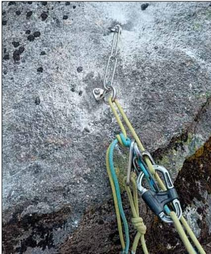
*Kettenstände mit Ring oder Karabiner dienen im frisch sanierten und erweiterten Klettergarten am Gotthardmassiv dazu, am Ende einer Route, das Seil umzuleiten und den Kletterer wieder abzulassen.*
