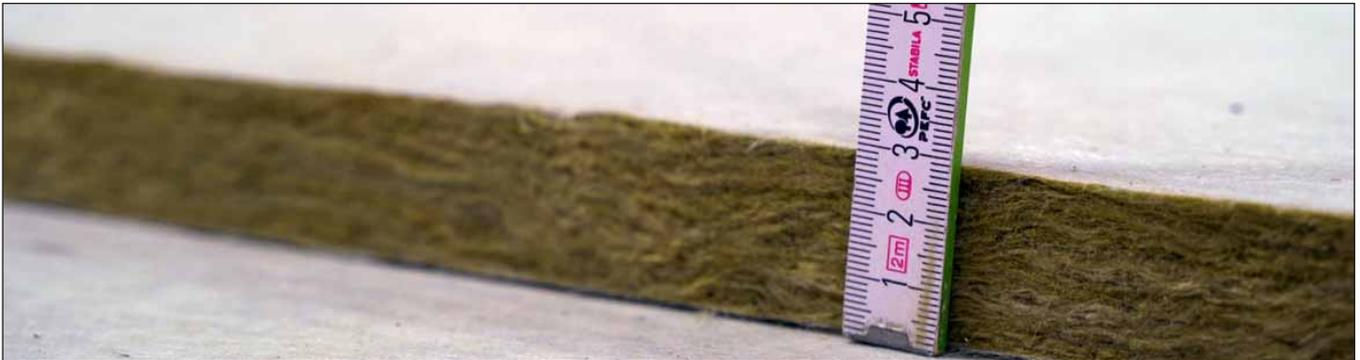
Das Inneo-System ist so einfach konzipiert, dass es mit nur zwei Dämmstoffstärken auskommt, nämlich 30 und 60 mm.
