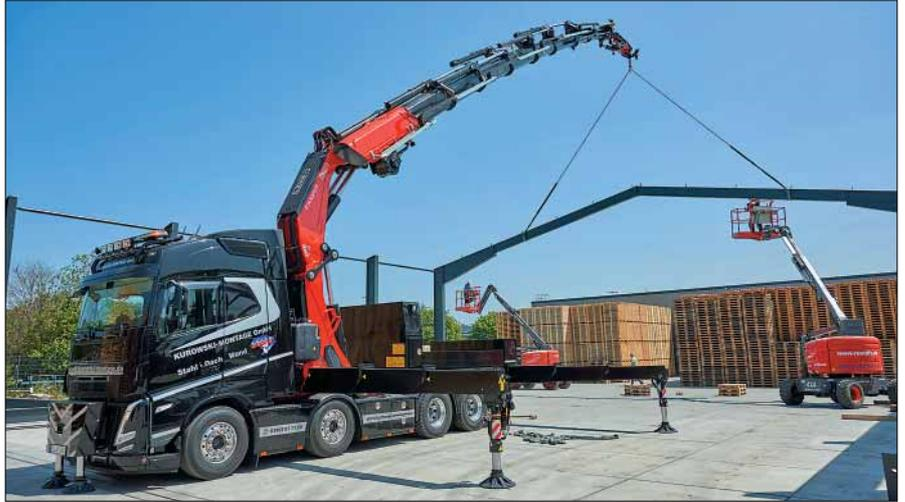
Die doppelte Frontabstützung erlaubt mehr als 80 % der max. Hubkraft – auch über der Fahrerkabine.
